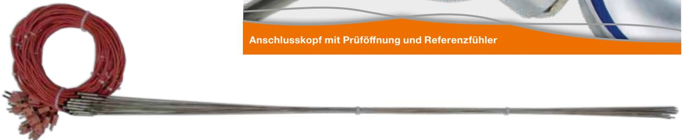
Kalibrierte Prüfelemente zur Durchführung von SAT-Messungen
